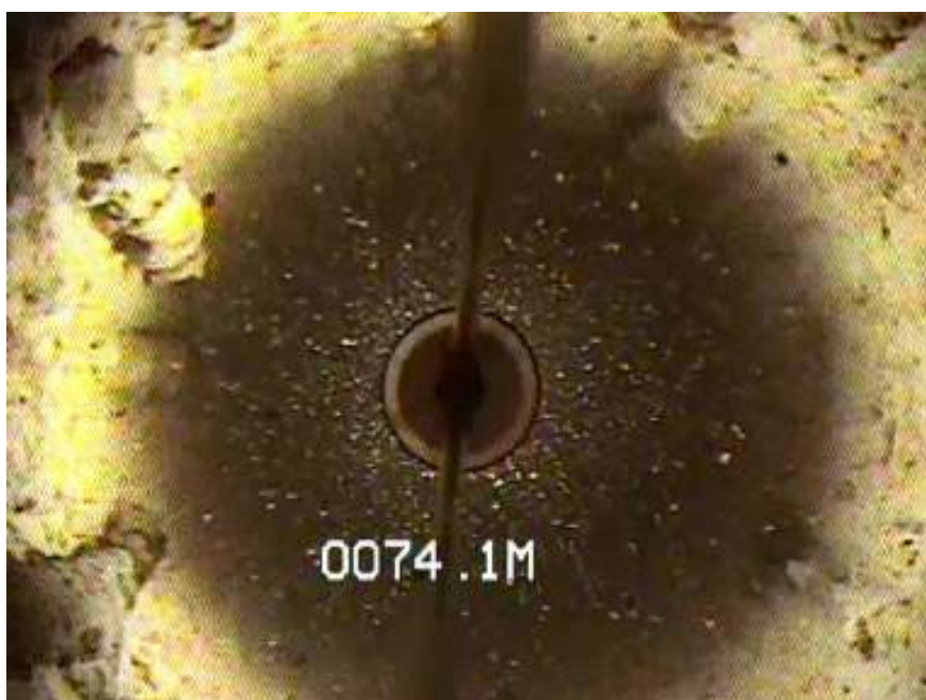
Figura 12. Visió axial. Incrustacions en forma allargada.
